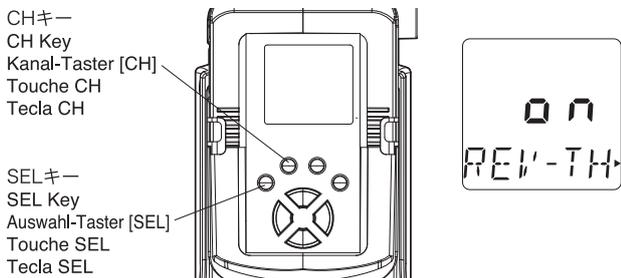
「SEL」キーを押し REV 設定画面を呼び出し、「CH」キーを押して「REV-TH」の表示にし、その際「ON」になっていればリバー스가設定されています。
