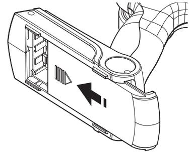
乾電池の交換時期 / Changing Batteries / Das Wechseln der Batterien /
